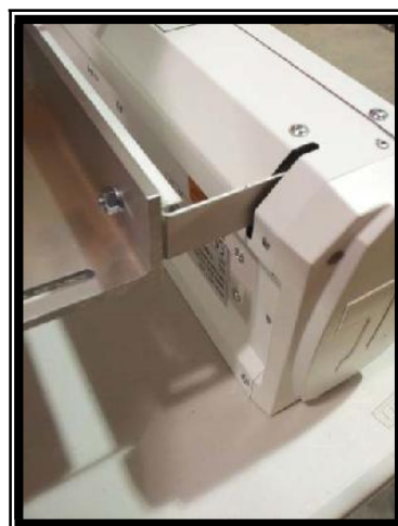
6 Suspender le DTAC au MB
