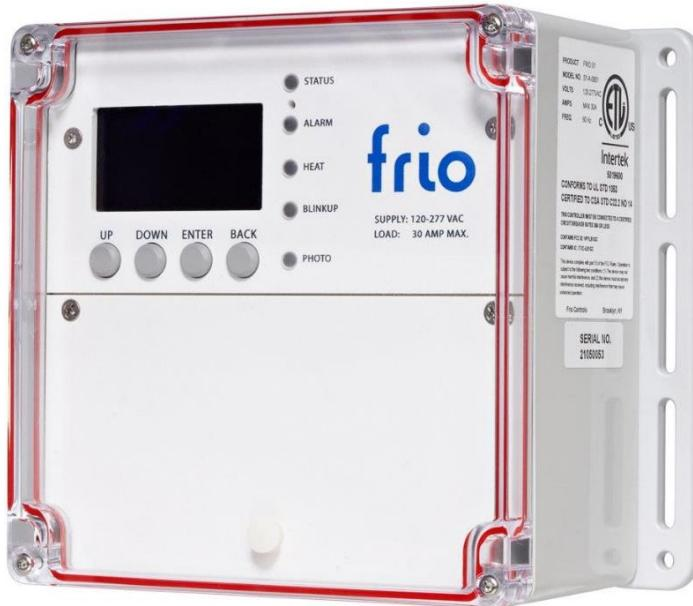
Le Frio S1 est un contrôleur de traçage thermique IoT à circuit simple conçu pour les applications de fonte des neiges de protection contre le gel et de maintien de la température. L'appareil est capable de gérer des charges résistives allant jusqu'à 30 A afin de contrôler les systèmes de traçage électrique opérant dans une plage de tension comprise entre 120 V c.a. et 277 V c.a. Le Frio S1 est livré dans un boîtier résistant aux intempéries qui est conforme aux normes IP67 et NEMA 4X.
