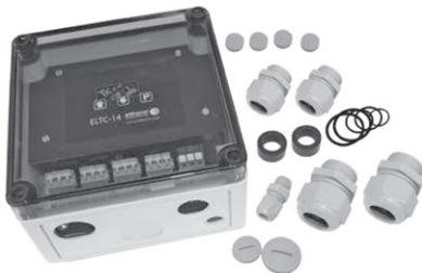
ELTC-14-RTD 1 : Contrôle de température mural à affichage digital dans un boîtier de plastique à l'épreuve des intempéries. Relais de puissance de 20A à 90-260V. Inclus le RTD 3 fils (Pt-100) élément sensible de 5 x 50 mm avec fils d'alimentation en fluoropolymère de 16.4 pi (5 m), plage de température de 0 °C à 250°C (32 °F à 482 °F).
